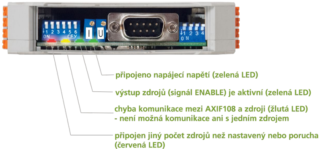
Abb. 12 - Beschreibung der Melde-LEDs
