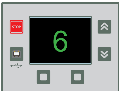
Na displeji je zobrazeno číslo nabíjecího místa s baterií určenou k odebrání.
